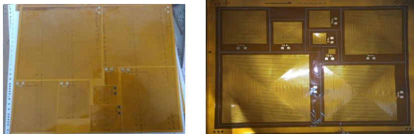
圖 9 用 PCB 軟板技術，一次製作完成「不同大小之揚聲器鼓膜元件」外觀圖。
