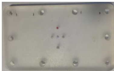
圖 10 熱對流傾斜計「底板」為便宜的「壓克力材料」。
